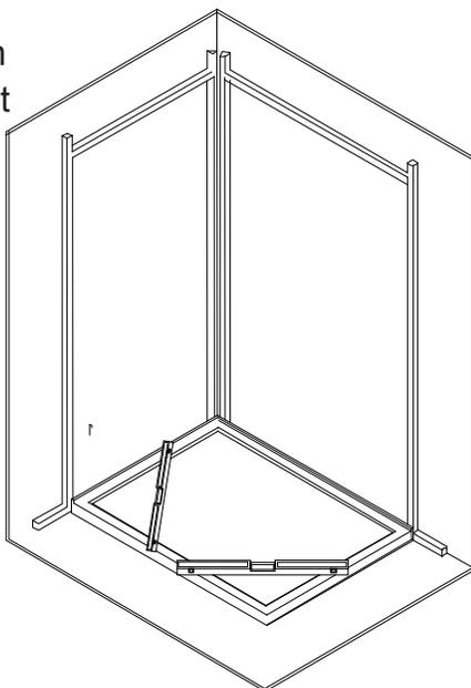
5、 Poser le bassin à l'emplacement d'installation, vérifier la pose soit horizontale avec l'aide de niveau à lunette.
