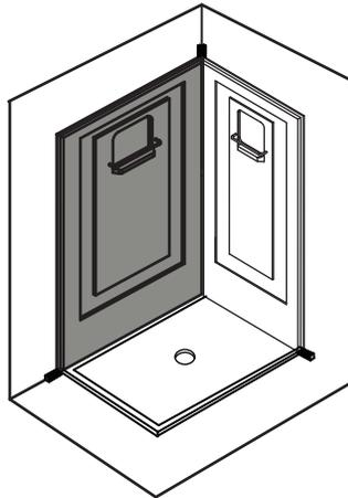
8、 Comme indiqué, poser les plaques de dos de différente taille déjà liées sur le bassin fixé, fixer les plaques de dos sur le paroi.
